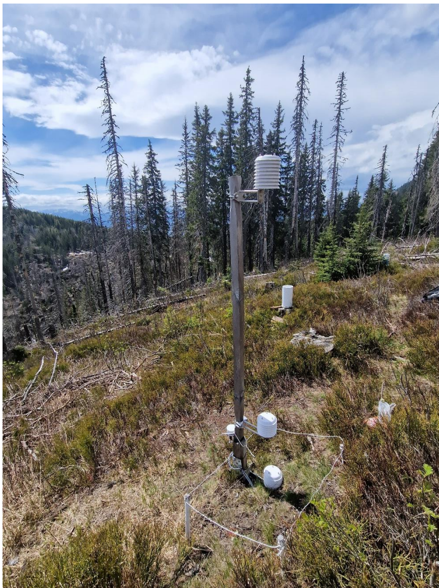
Foto 6: Mikrometeorologická stanica na rúbanisku v lokalite Červenec zameraná na monitoring stupňa požiarneho nebezpečenstva
