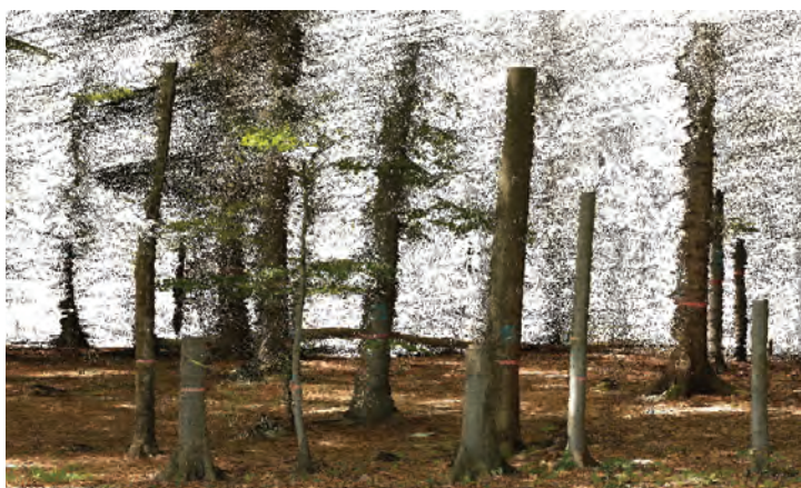
Obr. 3 3D model lesného porastu vytvorený blízkou pozemnou fotogrametriou
