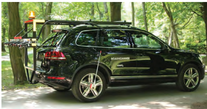
Obr. 1 Mobilné skenovacie zariadenie namontované na vozidle kategórie SUV
