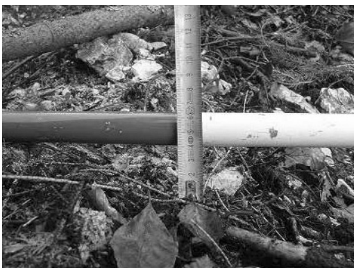
Obr. 2 Meranie hĺbky koľaje pomocou výtyčky
