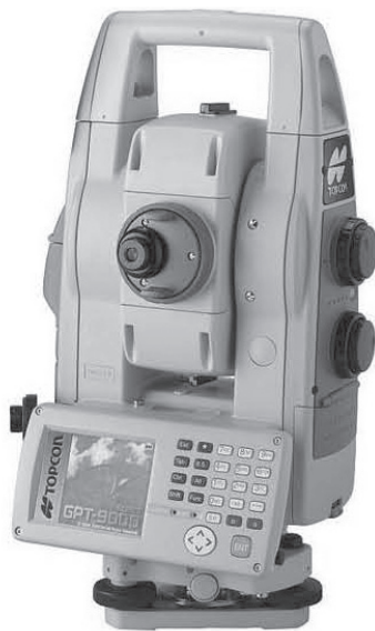
Obr. č. 2 Totálna stanica GPT-9003M ( www.geodis.sk )
