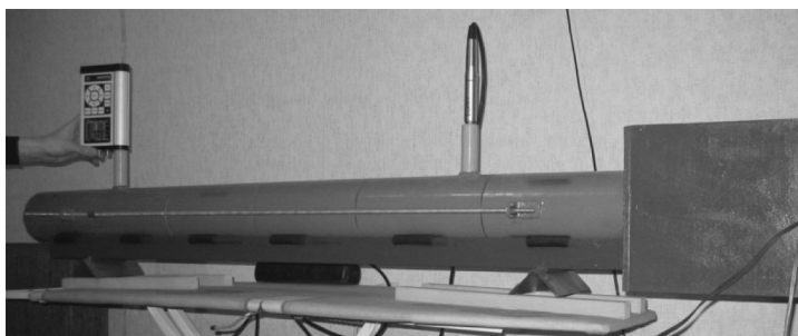
Рис. 2. Экспериментальная установка с установленным шумомером и микрофоном
