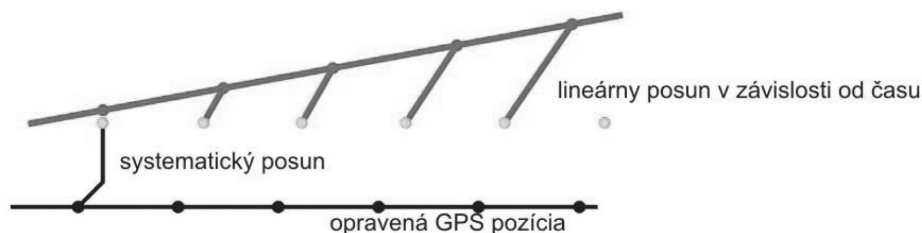
Obr. 2 Systematické chyby v určení projekčných centier snímok (INPHO, 2012)
