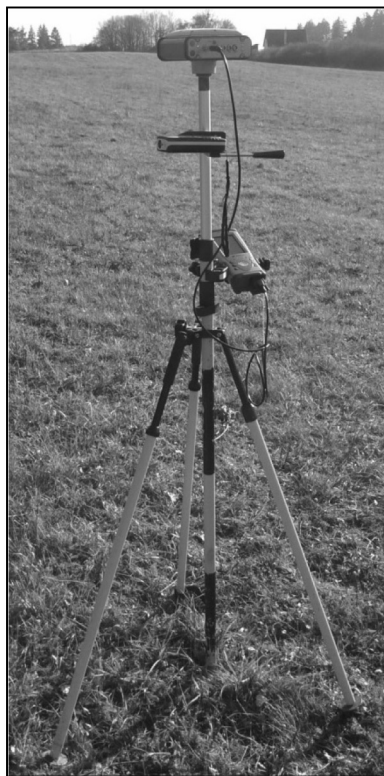
Obr. 9 Zostava prístrojov s Leica Disto D5 Fig. 9 Instrument assembly Leica Disto D5
