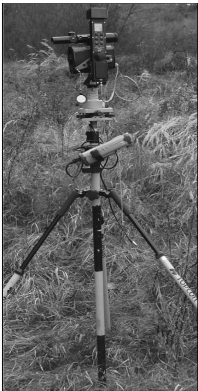
Obr. 8 Zostava prístrojov Impulse LR 200 a GNSS Fig. 8 Instrument assembly Impulse LR 200 a GNSS
