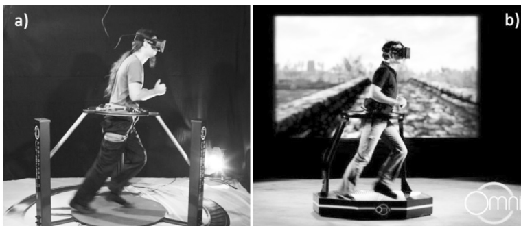
Obr. 2 a) technológia Cyberith Virtualizer, b) technológia Virtuix Omni. Obrázky boli prevzaté z webových stránok výrobcov
