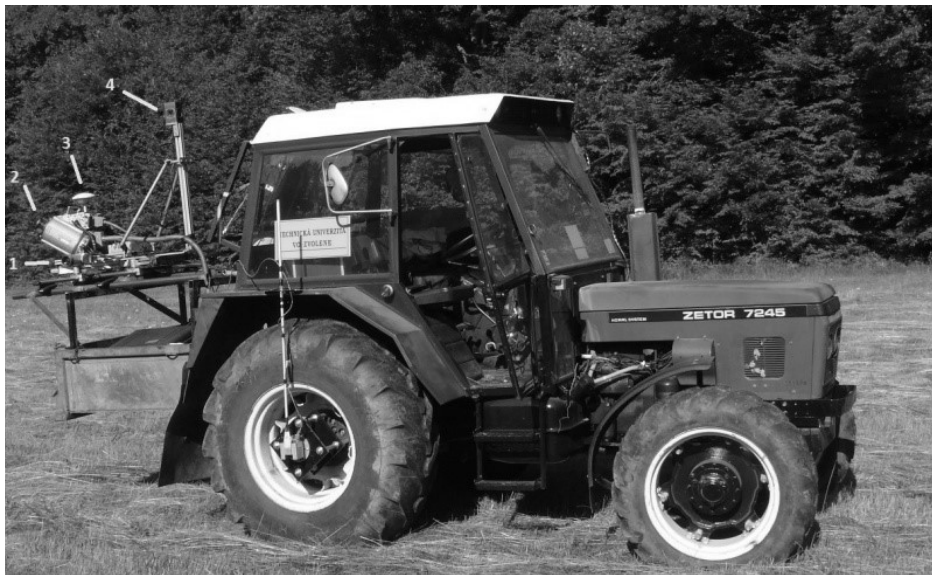
Obr. 2: Mobilný mapovací systém Riegl VMX-250 nasadený na UKT Zetor Horal 7245. Dve digitálne kamery (1) a mobilné laserové skenery VQ-250 (2) sú pripevnené stranách meracej hlavy, GNSS anténa (3) je umiestnená na vrchu meracej hlavy a panoramatická kamera (4) je umiestnená nad meracou hlavou mobilného mapovacieho systému.
