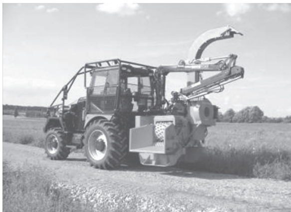
Obr. 5 Štiepkovací stroj Doppstadt Grizzly DT 32
