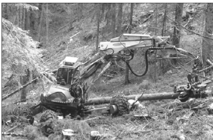
Obr. 1 Harvester Kaiser S2 pri práci
