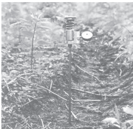
Obr. 6 Ľahký statický penetrometer STP – A
