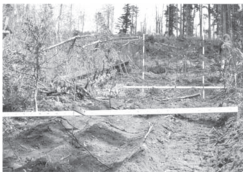
Obr. 5 Mikronivelačné meranie poškodenia približovacej linky po ťažbe
