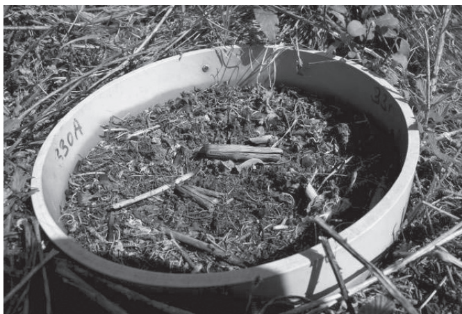
Obr. 1 Spodná časť bezodnej komory na meranie pôdnej respirácie, trvalo osadená na výskumnej ploche
