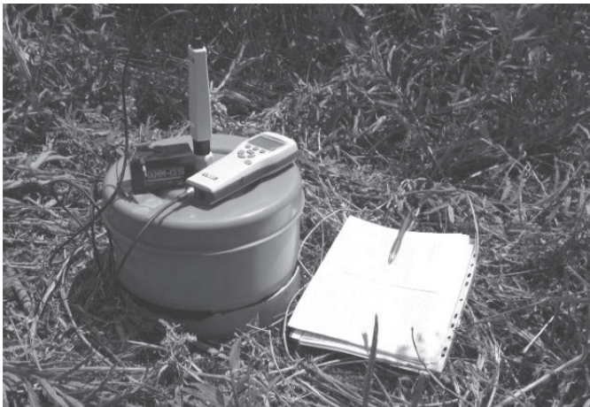
Obr. 2 Uzatvorená komora počas merania pôdnej respirácie Fig. 2 Enclosed chamber during measurement of soil respiration
