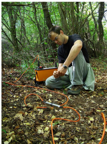
Obr. 1. Meranie elektrickej rezistivity pôdy priamo v teréne.
