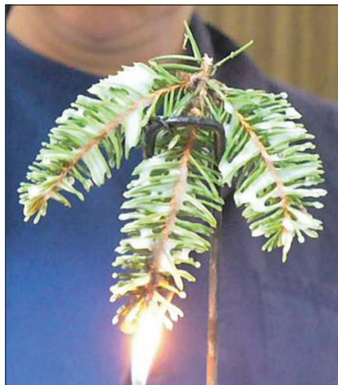
Ošetrená vzorka po dvoch minútach pôsobenia otvoreného ohňa
