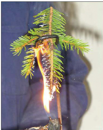
Horenie neošetrenej vzorky v prvej minúte horenia
